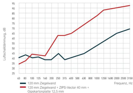
Luftschalldämmung,  $\Delta R_w$
