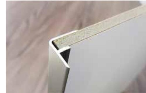
18a. **Eckprofil (Innen- und Außenecke) 1. Schritt:** dient der formschönen Ausführung von Innen- und Außenecken. Zunächst wird in beide Profilloffnungen Abdichtungskleber TS 40 Merbenit eingegeben. Bitte bei der Dosierung den Angaben des Hersteller Folge zu leisten. Anschließend wird das Profil zur Längsseite des ersten Boards aufgeschoben. Bei nicht symmetrischen Ecken oder nicht in Waage liegenden Wänden, empfiehlt sich eine vorherige Fixierung der Schiene am Einsatzort.
