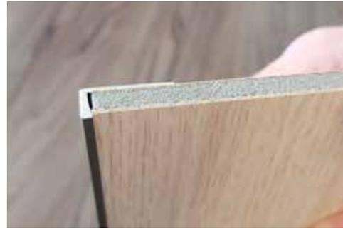
17. **Abschlussprofile:** Das Abschlussprofil ist für die Bekantung von Schmalseiten des HOMAPAL Aquaris SpaBoards vorgesehen. In die Profillinenseite des L-Profils wird Abdichtungskleber TS 40 Merbenit eingearbeitet und anschließend das Profil an die Längsseiten des Boards angedrückt. Die Verbindung von Profil und Board erfolgt wasserdicht. Ausquellender Kleber muss umgehend von der Oberfläche entfernt werden.
